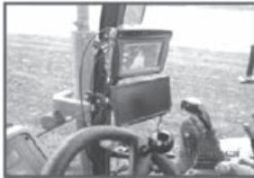
GPSオートパイロット補助装置により経験の浅いオペレーターでも高精度の作業が可能に
