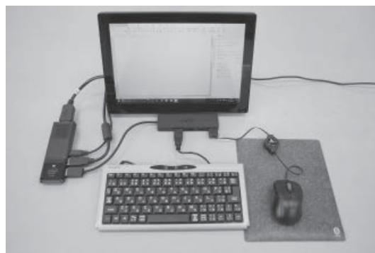
(図6) スティック型コンピューターとモニター、キーボードなどとの接続
