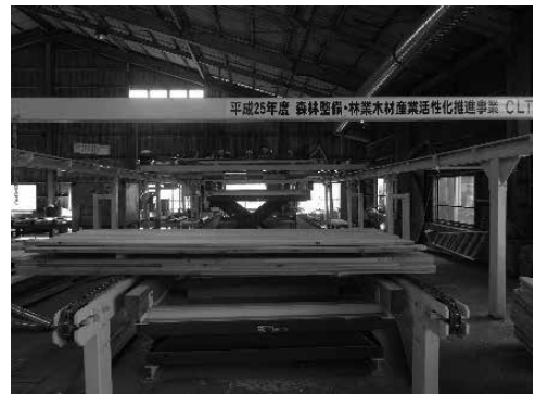
山佐木材の CLT 製造ライン
