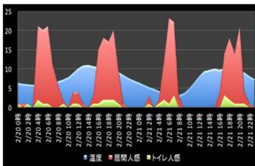
図7-9 人感センサーによる居間における移動認識とトイレの利用回数
