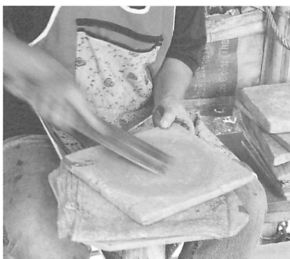
図16 ナデ板による敷板の汚れのこすり落とし
